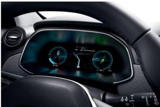
Die Anzeige bildet die wichtigsten Fahr-Informationen ab mitsamt den für den Elektroantrieb spezifischen Parametern – allem voran mit einem Eco-Fahrassistenten, der zum sparsamen Umgang mit der Energie animiert.
